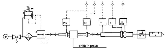
• Prove di portata eseguite dal Dipartimento di Meccanica del Politecnico di Torino, utilizzando il banco di misura computerizzato e seguendo le indicazioni della raccomandazione CETOP RP50R (recepta dalla ISO DIS 6358-2) con misuratore a diaframma ISO 5167.
